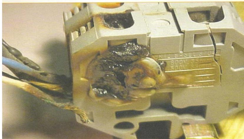
Esempi di incendio elettrico su quadro elettrico, scatola di derivazione, armadi metallici contenenti batterie di condensatori, interruttore di quadro.
